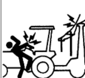
Tenha precaução quando circular debaixo de cabos elétricos de alta tensão.
