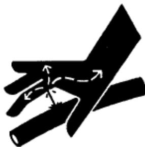
Não verifique vazamentos no circuito hidráulico com as mãos, a alta pressão pode provocar grave lesão.
