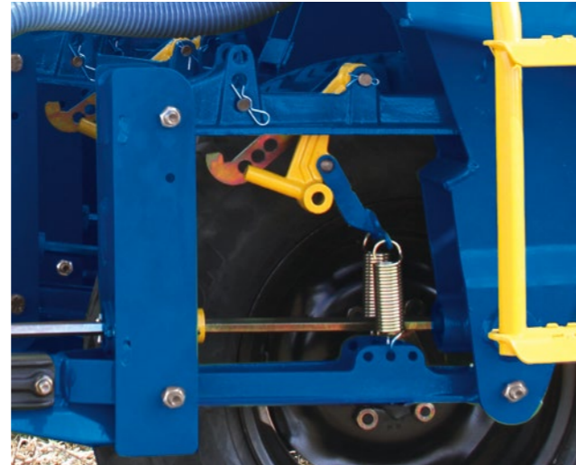
Sistema Pantografico en la Semilla: garante el acompañamiento de las variaciones de la topografía del suelo, permitiendo deposición de semillas siempre en la profundidad correcta.
