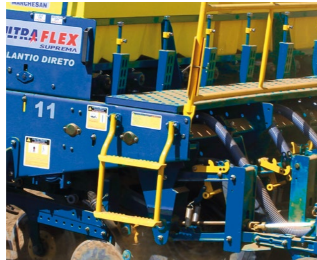
Recambio de Engranajes: con exclusivo sistema TRA – son 43 combinaciones en el abono y 23 en la semilla, sin uso de herramientas.
