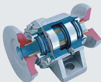
**CHUMACERAS** con dos rodamientos cónicos, lubricados a grasa (CM) o en baño de aceite - DUROMARK® (DM) Rodamientos de Rodillos Cónicos y Retenes Duo-Cone.
