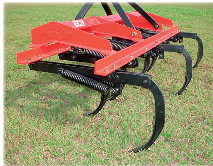
El **ECH** posee estructura de alta resistencia, siendo utilizado para escarificar y cultivar en las entrelneas de maíz soya, frijól, algodón, mani, etc., a si como en la eliminación de hierbas dañinas.
